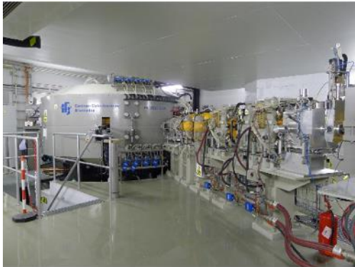
Proteus C-235 cyclotron protons 70-230 MeV
